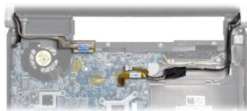
7. ディスプレイ接地ケーブルをシステム基板に固定しているディスプレイケーブル接地ネジを取り外します。
