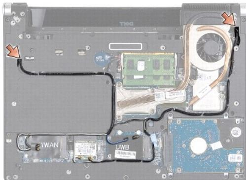
5. ミニカードケーブルをシステム基板から引き出して、コンピュータベースから取り出します。
