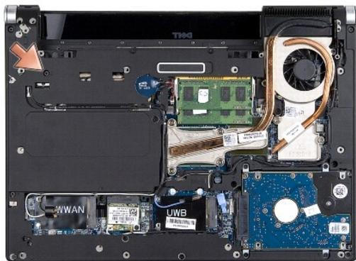
4. コンピュータを表に戻して、光学ドライブをシステム基板に固定している 2 本のネジを外します。
